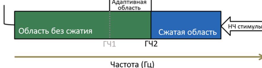
Рис. 1: Иллюстрация концепции частотной компрессии выходного сигнала при выключенном SoundRecover (верхний блок), включенном SoundRecover (второй сверху блок) и двух альтернативных вариантах SoundRecover2 (два нижних блока). "ВЧ стимулы" и "НЧ стимулы" обозначают преобладание, соответственно, высокочастотной и низкочастотной энергии во входном сигнале.
