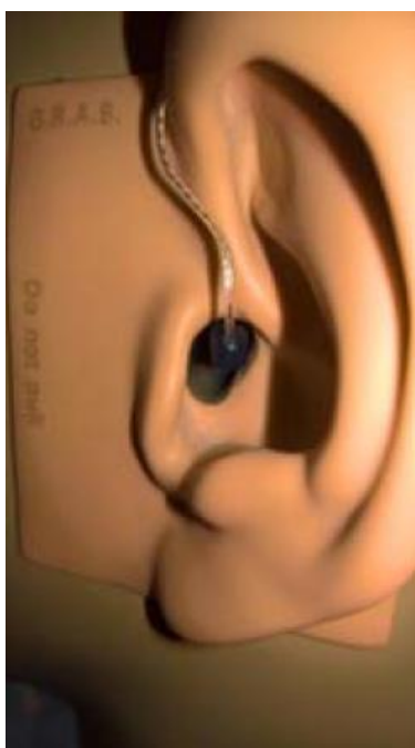
Рис. 2: Антропометрическая ушная раковина манекена KEMAR с надетым на нее слуховым аппаратом (используется мощный стандартный вкладыш Power Dome).
