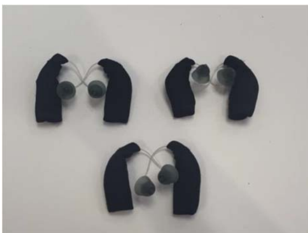
Рис. 2: Слуховые аппараты, помещенные в чехлы и снабженные одинаковыми мощными стандартными вкладышами.
