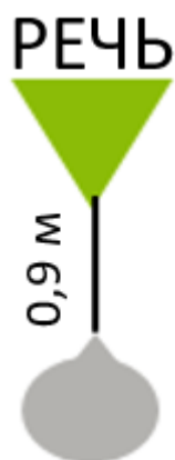
Рис. 6: Схема ситуации "Тихая речь", предназначенной для сравнения показателей разборчивости речи при использовании автоматических систем классификации трех производителей.
