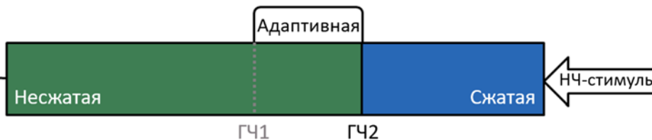
Рис. 1: Концептуальная иллюстрация частотного распределения энергии в выходном сигнале: SoundRecover выключен (верхний график), SoundRecover включен (второй сверху), два альтернативных режима частотной компрессии SoundRecover2 (два нижних графика). Термины "ВЧ-стимулы" и "НЧ-стимулы" означают преобладание высоко- и низкочастотной энергии во входном сигнале, соответственно.
