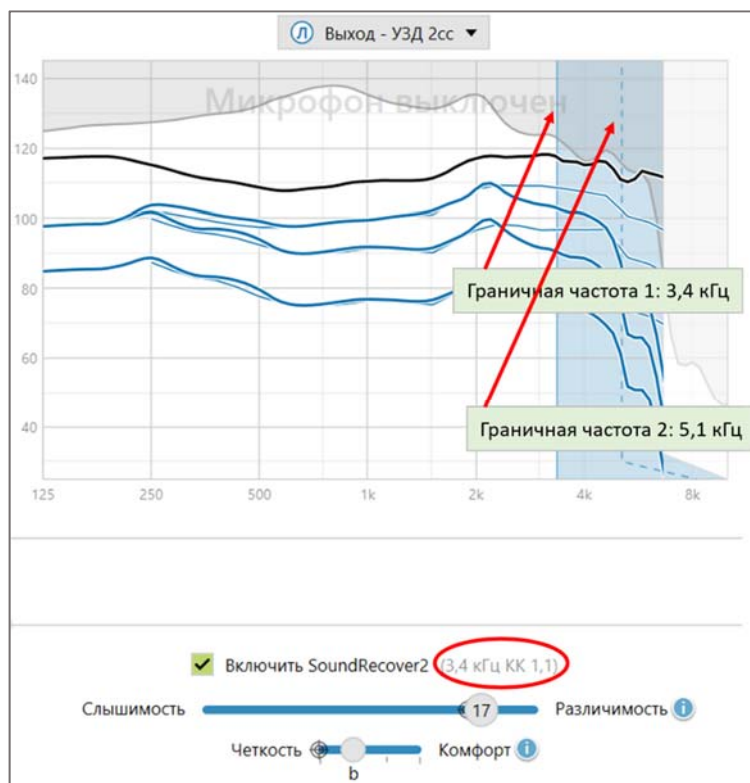
Рис. 5: Скриншот модуля настройки SoundRecover2 в программе Phonak Target с двумя регуляторами – "слышимость-различимость" и "четкость-комфорт". Показаны также значения ГЧ1 и ГЧ2. Числовые значения ГЧ1 и КК отображены над верхним регулятором (обведены красным).
