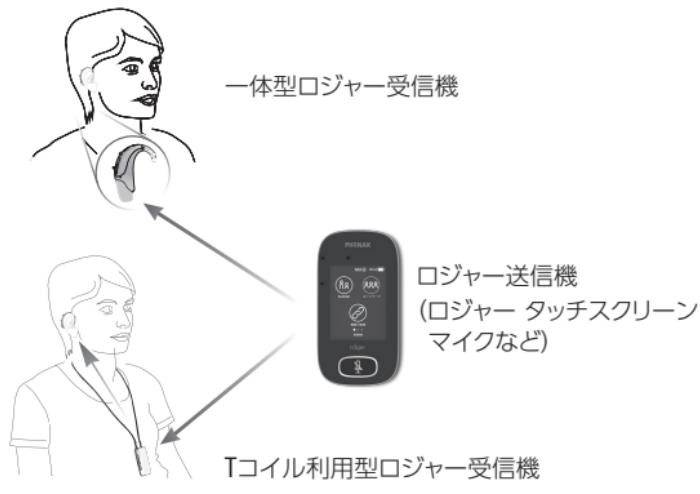
送信機：マイクロホンを話し手の口元やスピーカーの近くに設置、もしくは外部入力に音源を接続します。
