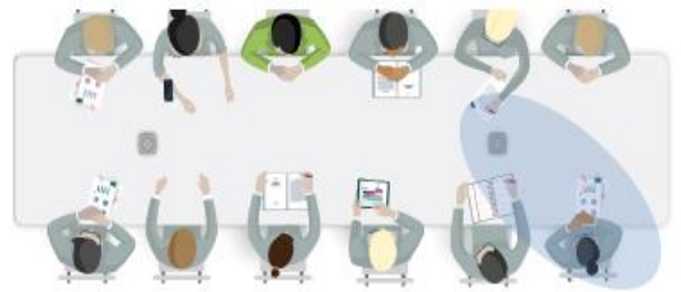
Figura 5b: El diagrama ilustra una reunión grande con un Table Mic II ubicado en cada extremo de la mesa de conferencia. La tecnología MultiBeam selecciona y activa un solo haz con la mejor SNR, mostrado en azul. El oyente se muestra en verde.
