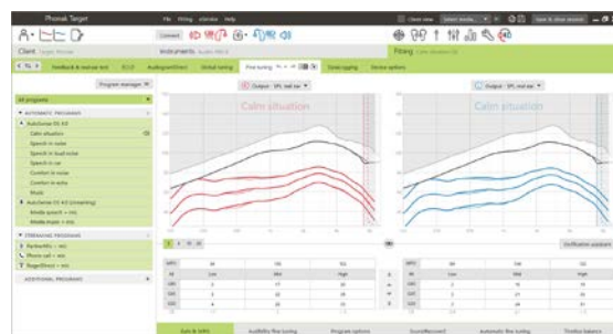
Le schede presenti nella parte più bassa della schermata consentiranno l'accesso agli strumenti di fitting. Ogni strumento è dotato di variazioni specifiche per eseguire la regolazione fine dell'apparecchio acustico.
